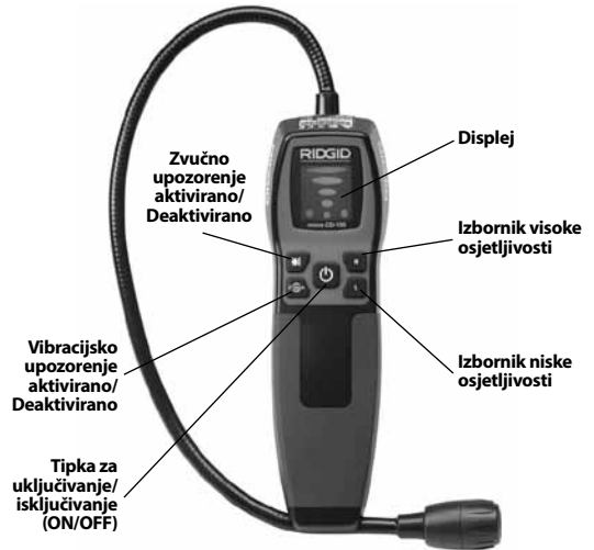
Slika 2 – Dijelovi uređaja mikro CD-100
