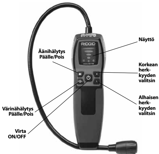
Kuva 2 – micro CD-100 -laitteen osat
