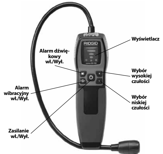
Rysunek 2 – Części micro CD-100
