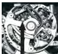
Figura D - Locația perilor de carbon. În cele din urmă, este posibil ca acest articol să trebuiască să fie înlocuit atunci când se uzează.
