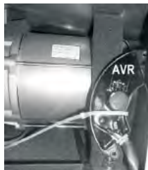
Figura B - Locația AVR (Regulator automat de tensiune). În cele din urmă, este posibil ca acest articol să trebuiască să fie înlocuit atunci când se uzează.
