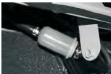
(A ábra - Évente egyszer cserélje ki az elülső hozzáférési panel belsejében található üzemanyagszűrőt)
