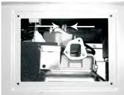
Figura A - Scoateți panoul lateral, apoi scoateți filtrul de aer. Localizați maneta de decompresie "Roșie" (Fotografia de mai sus o arată în poziția UP). Apăsăți maneta în jos - aceasta va ține supapa de evacuare deschisă. Înlocuiți ansamblul filtrului de aer. Porniți motorul. Veți observa că maneta cu arc va reveni automat în poziția UP. (De asemenea, menționată ca ansamblu arbore decompresie pe diagrama piese.)
