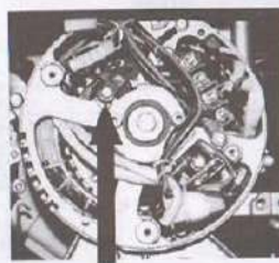
Figura D – Căutați locația perilor de cărbuni. Este posibil ca acest element să trebuiască să fie schimbat când se uzează excesiv.
